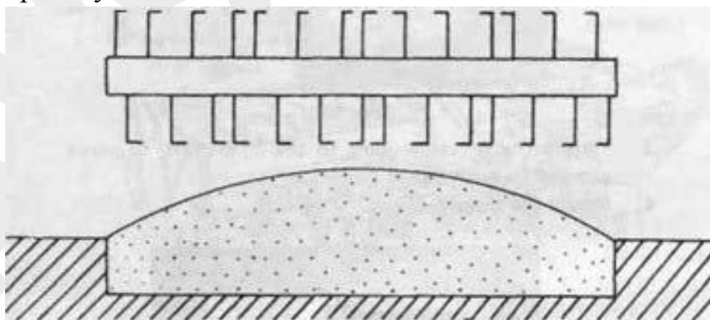
При установке затяните болты крепления ножей почвенной фрезы до момента затяжки 4 ~ 5 кгс/м. Не забывайте подтянуть их перед каждым началом работы, поскольку во время эксплуатации ножи постоянно подвергаются ударам.
